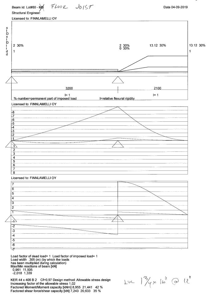
Deflection due to unfactored load (Deflection limit L/360)/L/180)! 0,2 mm (3 %) 11,3 mm (97 %)
