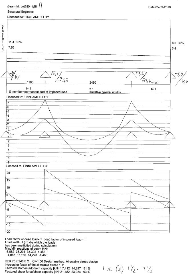
Deflection due to unfactored load (Deflection limit L/360) 0,0 mm (1 %) 3,1 mm (45 %) 0,0 mm (0 %)
