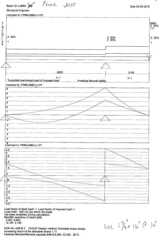
Deflection due to unfactored load (Deflection limit L/360)/L/180)! 0,9 mm (7 %) 8,6 mm (73 %)
